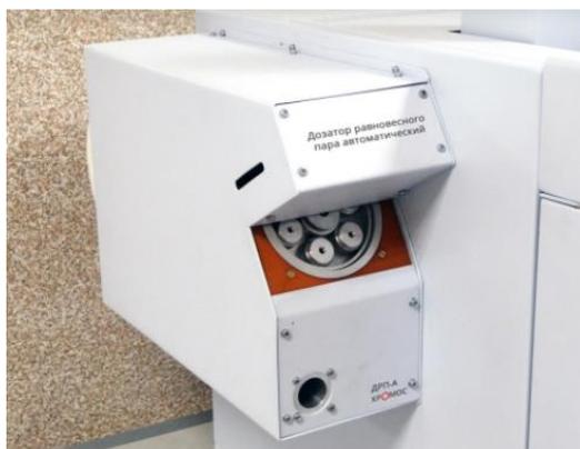
Предназначен для анализа летучих компонентов, находящихся в равновесной паровой фазе, извлеченной из пробы.
